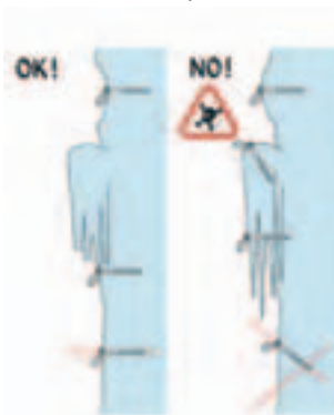
Obr. 4 – Šrouby v ledu, vlevo správně a vpravo špatně zašroubované
