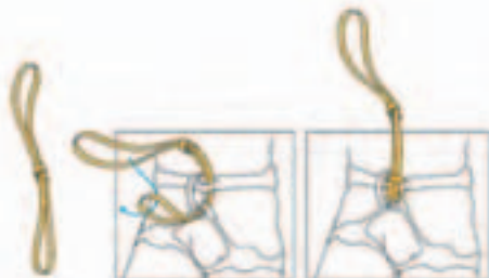
Obr. 1 – Příprava odsedávací smyčky ke slanění
