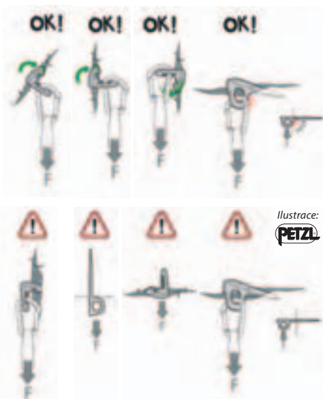
Obr. 3 – Pevnost zatlučené skoby závisí na tvaru skoby, způsobu umístění, kvalitě skály a zkušenosti uživatele, který ji umísťuje. Při pádu se skoba musí v trhlině zablokovat. Síla (F) přenášená karabinou kroutí ostří skoby. Toto zkroutení zablokuje skobu na svém místě. Skoba by neměla držet pouze díky tření nebo stlačení.
