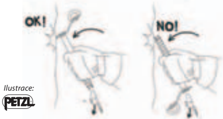
Obr. 6 – Vyklepání ledu ze šroubu
