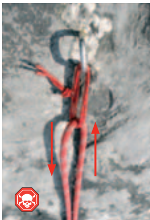
Obr. 4 – Nikdy nespouštějte pokud je lano provlečeno smyčkou – kvůli tření lana o smyčku dojde k rychlému přepálení smyčky a nejištěnému pádu
