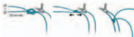
Obr. 2 – Prameny polovičních nebo dvojitých lan k sobě svažte vůdcovským uzlem
