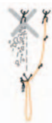
Obr. 1 – Štand má být na chráněném místě, aby led padající shora neohrožoval jističe na štandu
