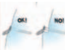
Obr. 4 – Šrouby v ledu, vlevo správně a vpravo špatně zašroubované
